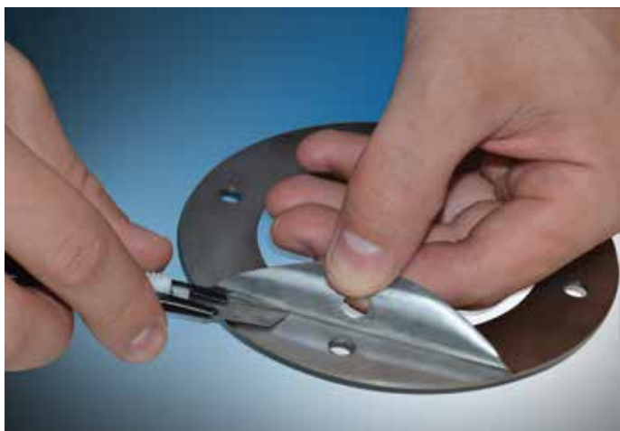
Les cales laminées à surface encollée doivent être ajustées à l'aide d'un outil.
