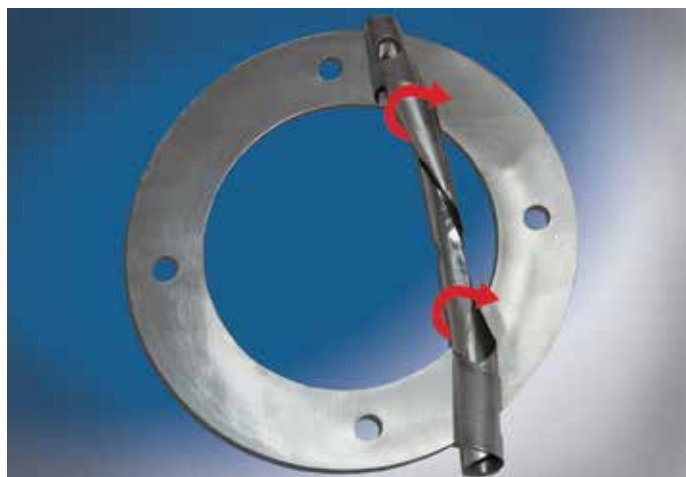
Déformation des couches non désirées sur des cales laminées à surface encollée
